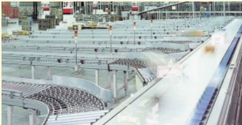
高速自動仕分けシステム ジェットサーフィンソーター
