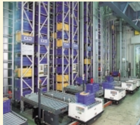
ケース保管用高速小型自動倉庫 ファインストッカー と 軌道式電動台車 ソーティングトランスピークル
