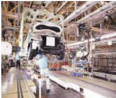
フリクション搬送システム 「フレキシブルドライブシステム」/自動車業界
